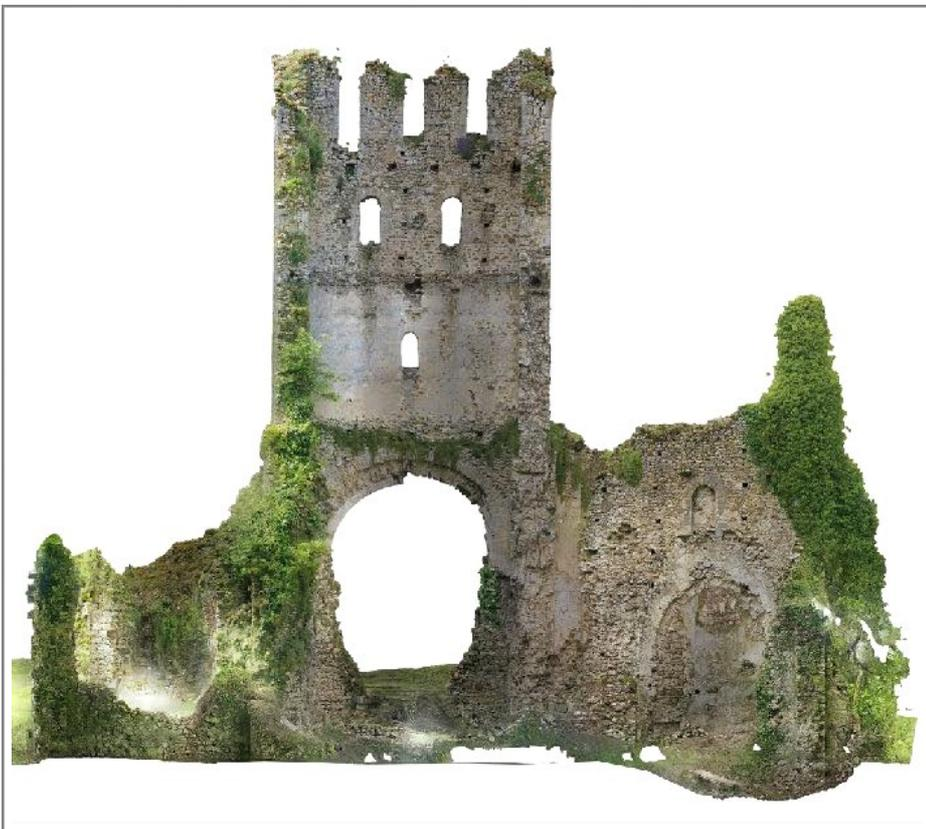
Quand à la *lasergrammétrie*, elle remplace l'appareil photo par un laser, statique ou embarqué sur un drone, pour produire un maillage complet de mesures 3D qui, une fois réunies, restitueront très précisément les volumes.
